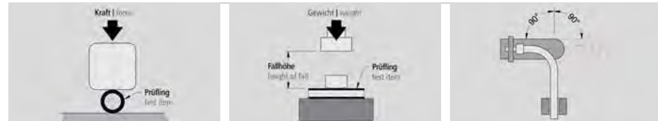
Querdrukprüfung nach Flexa Norm 1008 Compressions test acc. to Flexa norm 1008 Schlagprüfung nach Flexa Norm 1008 Impact test acc. to Flexa norm 1008 Flexibilitätsprüfung | Wechselbiegeprüfung nach Flexa Norm 1036 Flexibility test | Alternate bending test acc. to Flexa norm 1036
